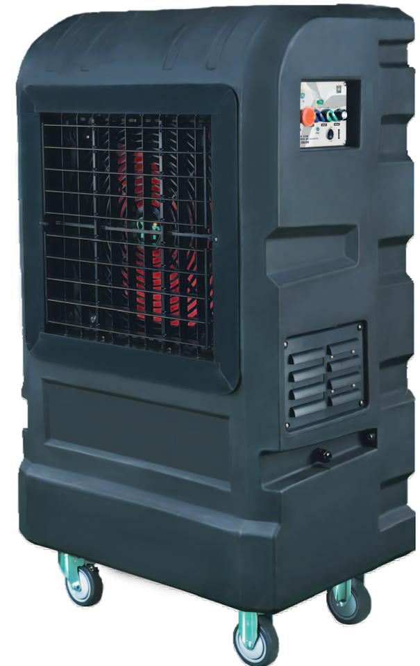
Der KM14 ist ein adiabatischer Luftkühler und überzeugt mit einem Luftdurchsatz von 14.000 m<sup>3</sup> pro Stunde. Je trockener und wärmer die angesaugte Luft ist, desto stärker wird die Temperatur der zugeführten Luft gesenkt. Unsere Verdunstungskühler verbrauchen bis zu 90 % weniger Energie als herkömmliche Klimaanlage.
